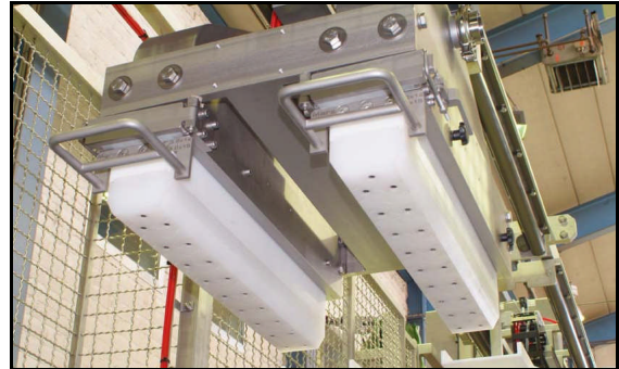
Abbildung 1: Düsenstock von unten mit montierten Kunststoffmatrizen
