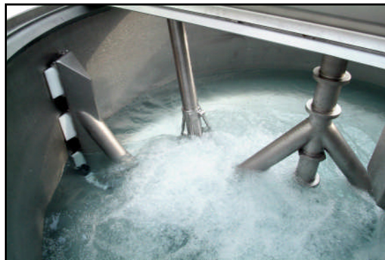
Abbildung 3: Blick von oben in den Rührkessel bei eingeschaltetem Leitstrahlmischer
