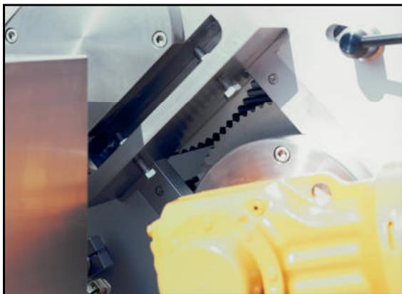
Abbildung 1: Crimper-Walzenpaar
